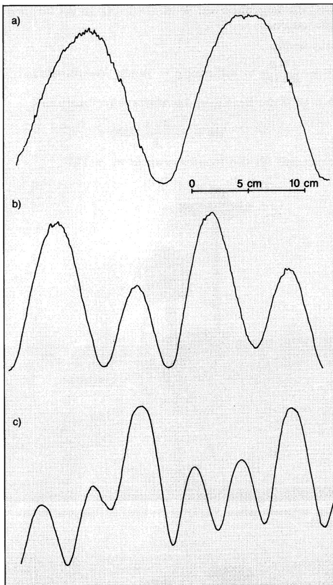
Abb. 6: Schreiberaufnahmen:  $g = 38 \text{ mm}$ ;  $a = 60 \text{ cm}$ ; a) Zwei Erreger in Phase; b) Drei Erreger in Phase; c) Vier Erreger in Phase
